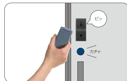
ピッという音と、ランプの点灯で解錠をお知らせします。
