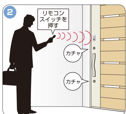
2 ドアに設置されたリーダーに向けてリモコンスイッチを押す。
