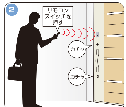
ドアに設置されたリーダーに向けてリモコンスイッチを押す。
