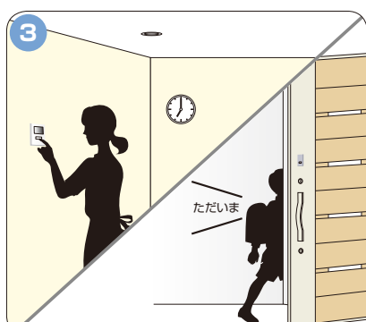
インターホンに付属の解錠ボタンを押す。/ドアの2つのロックを自動で同時に解錠。
