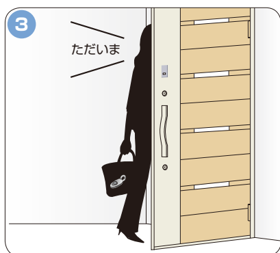
ドアの2つのロックを自動で同時に解錠。
