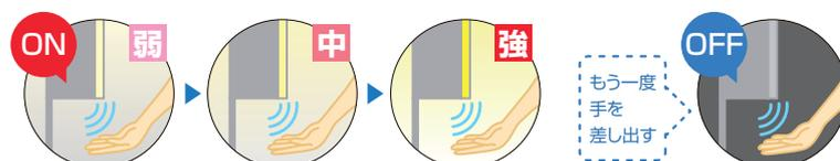
フェイスフルライトは、センサー部に手を差し出し続けるだけで、弱→中→強と明るさを調整できます。
