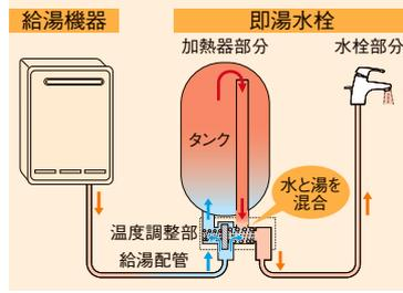
水栓を開くと、給湯配管内の水とタンクの湯を混合、適温(約36℃)で給湯。
