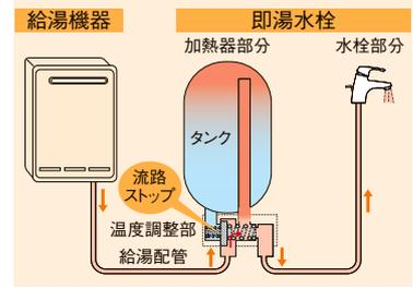
湯が来たら、タンク側への流路をストップ。給湯機器の湯をそのまま水栓へ給湯。
